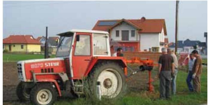
**Mit Erdbohren**, die von einem Traktor angetrieben werden, wurden Löcher in den Boden getrieben, um die Grenzsteine und Bodenmarken einsetzen zu können.
