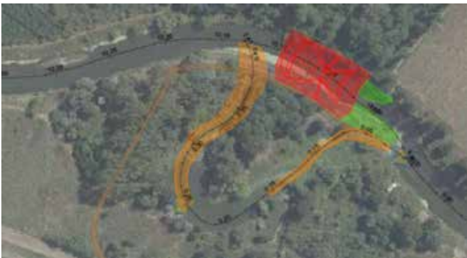
Durchstich 12, Planung zur Anbindung des abgetrennten Mäanders
